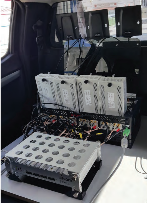
Şekil 8 - TEMS cihazlarının araç içerisindeki kurulumu
