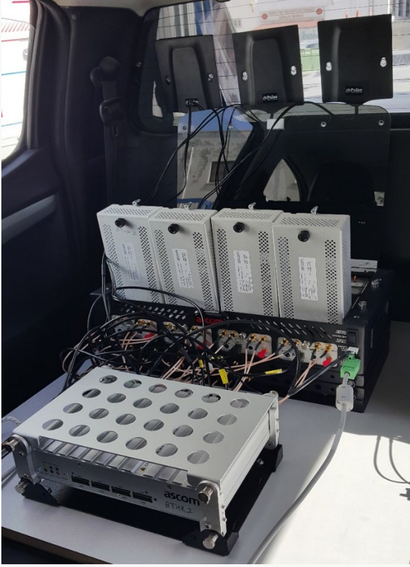
Şekil 12- TEMS cihazlarının araç içerisindeki kurulumu
