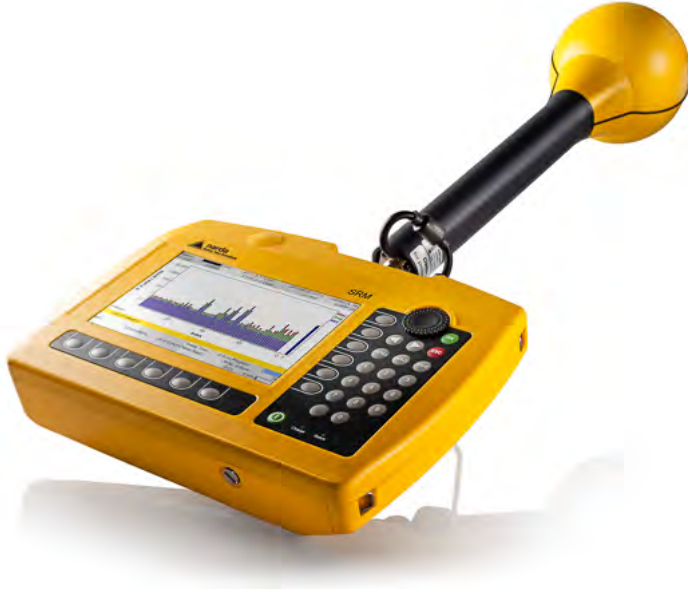
Şekil 2. SRM 3006 EM Alan Şiddeti Ölçüm Cihazı
