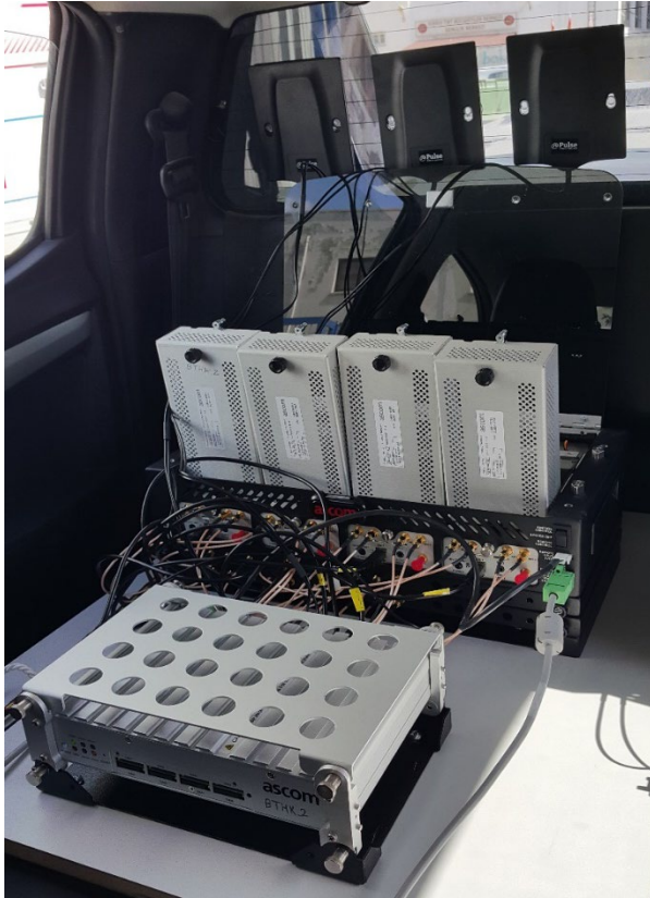
Şekil 8 - TEMS cihazlarının araç içerisindeki kurulumu
